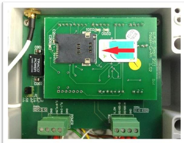
Abbildung 10: Einsetzen der SIM-Karte
