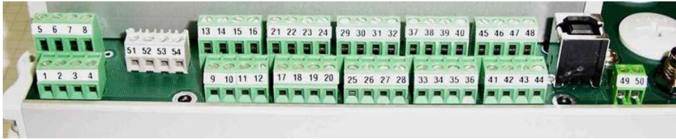
Abbildung 14: Reihenfolge der Klemmennummerierung - Schraub-Klemmen
